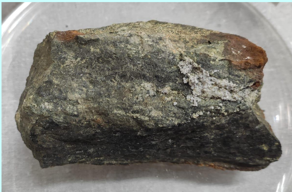
Figura 214- Melanterita, halotriquita e outros minerais secundários desenvolvidos a partir da oxidação de pirita em rocha máfica/ ultramáfica. Serrinha, Formiga- MG.
