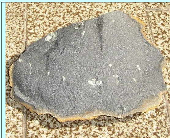
Figura 28 -Diabásio porfirítico (poucos fenocristais brancos de plagioclásio) com textura em transição para rocha basáltica (afanítica). ASADEF, Formiga- MG
