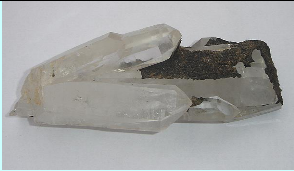
Figura 121- Quartzo hialino com crosta manganesífera. Amostra com cerca de 14 cm. São Pedro, Formiga –MG
