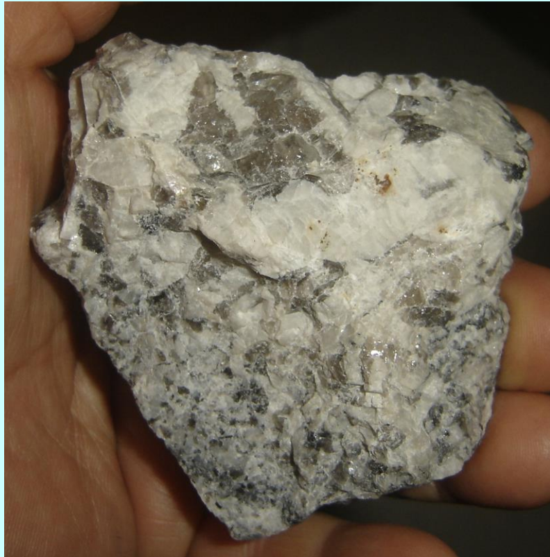
Figura 22- Pegmatito constituído de feldspato e quartzo. Cachoeira do Areião, Formiga- MG.
