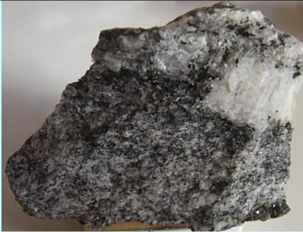
Figura 68- Gnaiss exibindo um grande porfiroblasto de feldspato branco. Cachoeira do Areão, Formiga- MG
