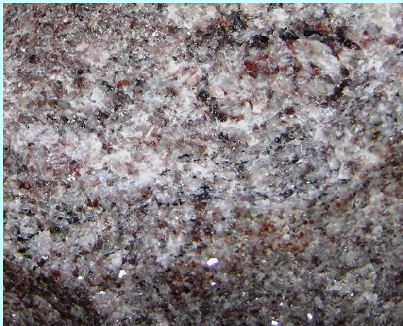
Figura 21- Granito "Itapecerica" róseo parcialmente metamorfoisado- BR 354, Usina Velha, Formiga- MG
