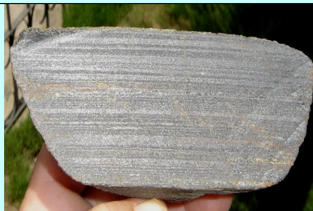
Figura 55- BIF praticamente inalterada exibindo níveis de óxidos de ferro e silicatos praticamente sem dobramentos. O espécime foi cortado e polido. Serrinha, Formiga -MG
