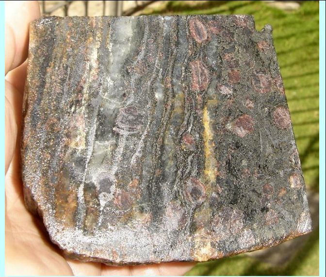
Figura 67- Gnaiss magnetítico granatífero exibindo abundantes porfiroblastos de granada vermelha. Alguns porfiroblastos chegam a medir cerca de dois centímetros em certos casos. Externamente estão pseudomorfizados. Serrinha, Formiga- MG
