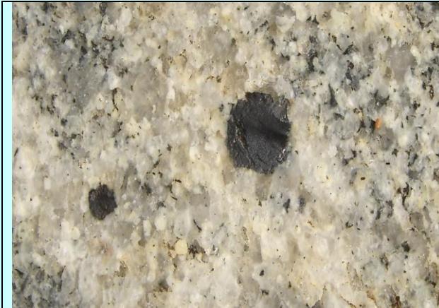
Figura 18- Rocha granítica leucocrática destacando cristais subeuédricos de magnetita. Estes se concentram na fase leucocrática. Cachoeira do Areão, Formiga- MG
