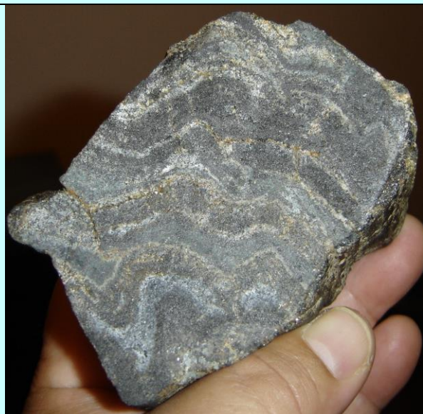
Figura 138- Níveis negros de magnetita na formação ferrífera bandada. Serrinha, Formiga –MG
